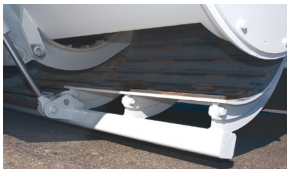
Очистные люки с гидроприводом на всех конвейерах.
