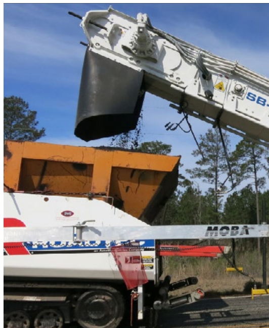
Автоматическая система контроля скорости загрузки укладчика материалом.
