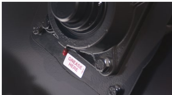
Наружные точки смазки для всех подшипников. Опция — система автоматической смазки.
