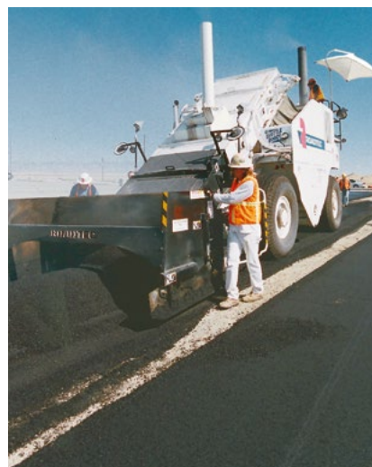
Вариант с навеской подборщика из валиков добавляет разнообразие в применении Shuttle Buggy.
