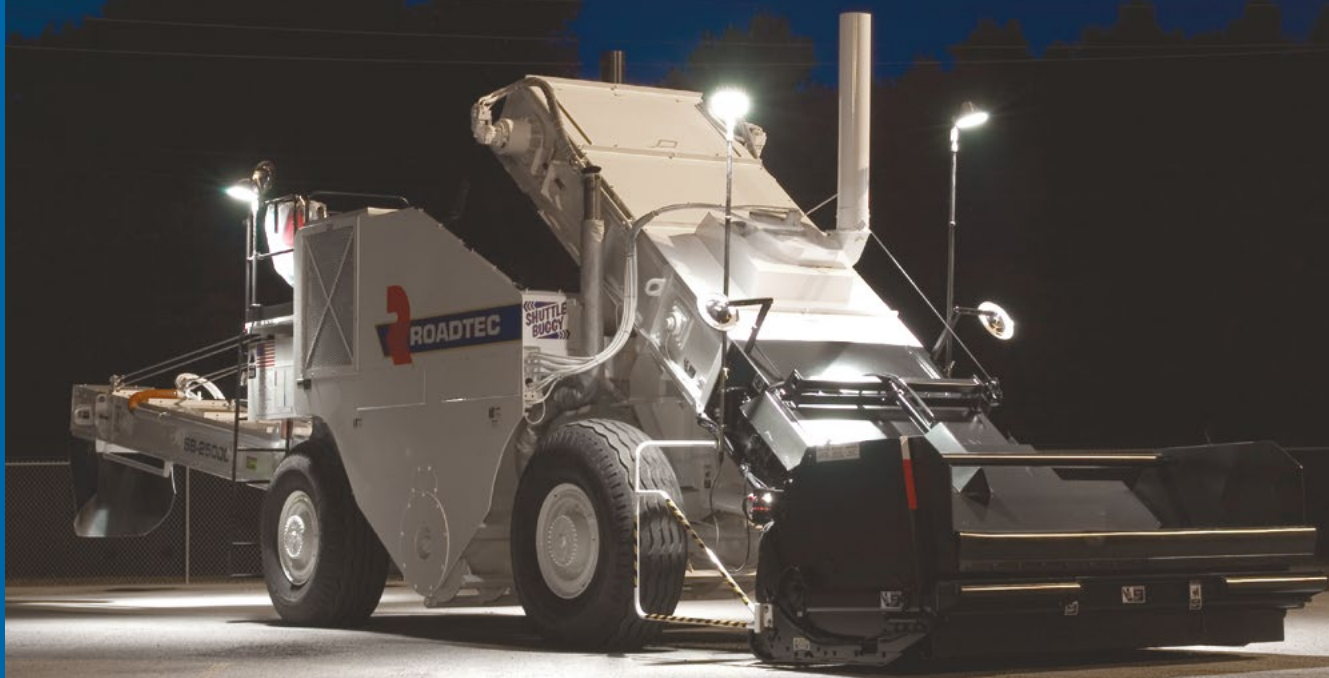
Перегружатель Shuttle Buggy с улучшенным комплектом осветительных приборов.
