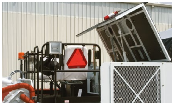
Гидравлика без усилий поднимает капот двигателя.
