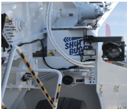
Светодиодный сигнал для сигнализации о действиях водителю грузовика.
