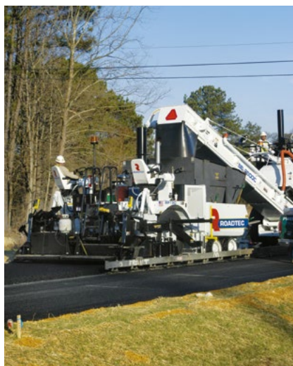
Низкие линии электропередач могут мешать самосвалам поднимать кузова. С перегружателем Shuttle Buggy такой проблемы не существует.
